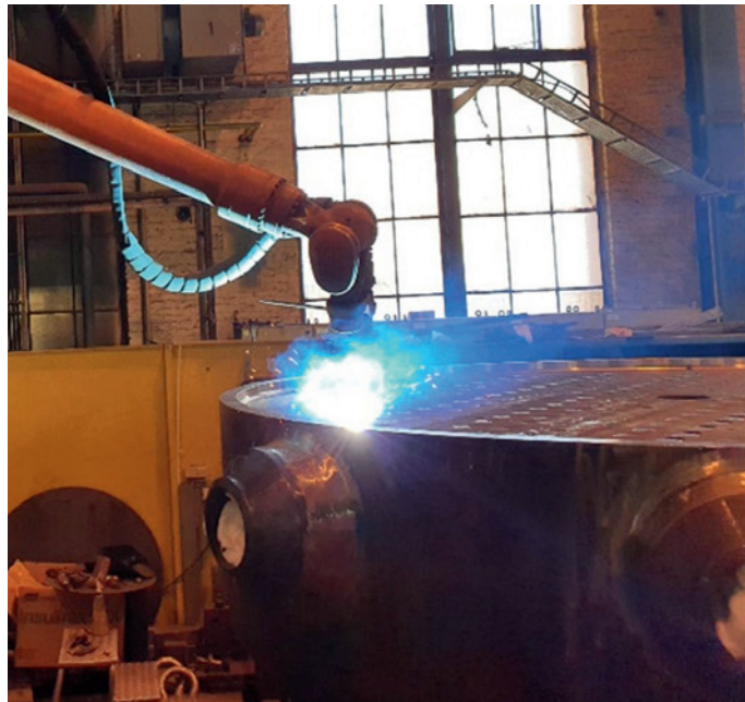
◀ Bild 8. Roboterschweißstation für Zuganker
