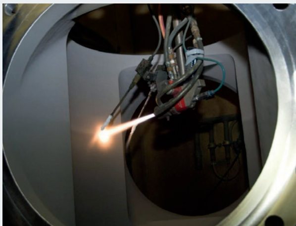
Thermisches Spritzen besonders beanspruchter Bauteile (Bild: rhv)
