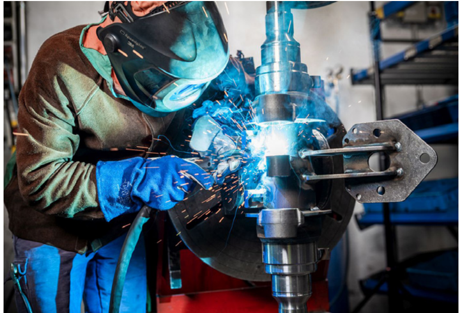
▲ Bild 3. Mit der Null-Fehler-Strategie als Maßgabe wird jede Schweißnaht mit den korrekten und vorgegebenen Schweißparametern hergestellt.
