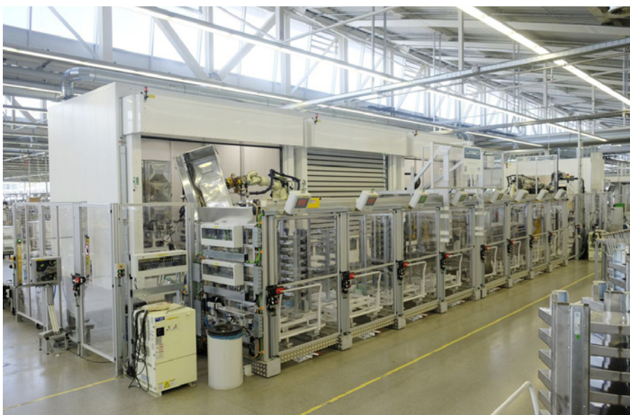
▲ Bild 1. Der vollautomatisierte Produktionsablauf im Überblick: Der im Vordergrund erkennbare Handhabungsroboter „FD-V210“ von OTC Daihen Europe bestückt die Laserstrahlschweißzellen, die entsprechenden Teile entnimmt er den vorgelagerten Bauteilbehältern.
