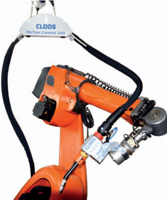
◀ Bild 2. Erweiterte Schweißausrüstung: Drahtpuffer innerhalb des Schlauchpakets und hochfrequenter Pull-Drahtantrieb
