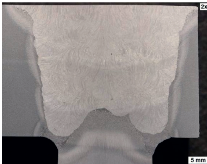
◀ Bild 9. Metallographische Untersuchung an MAG- engspaltgeschweißten Zugankern
