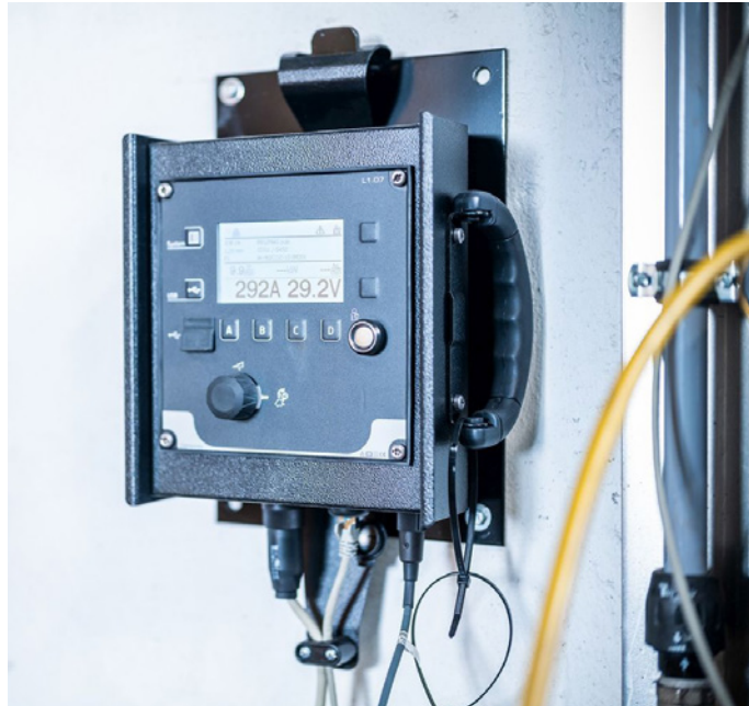
◀ Bild 5. Über das „Xnet“-Gateway werden die Schweißparameter direkt an den Server übertragen und können einem speziellen Bauteil zugeordnet werden.
