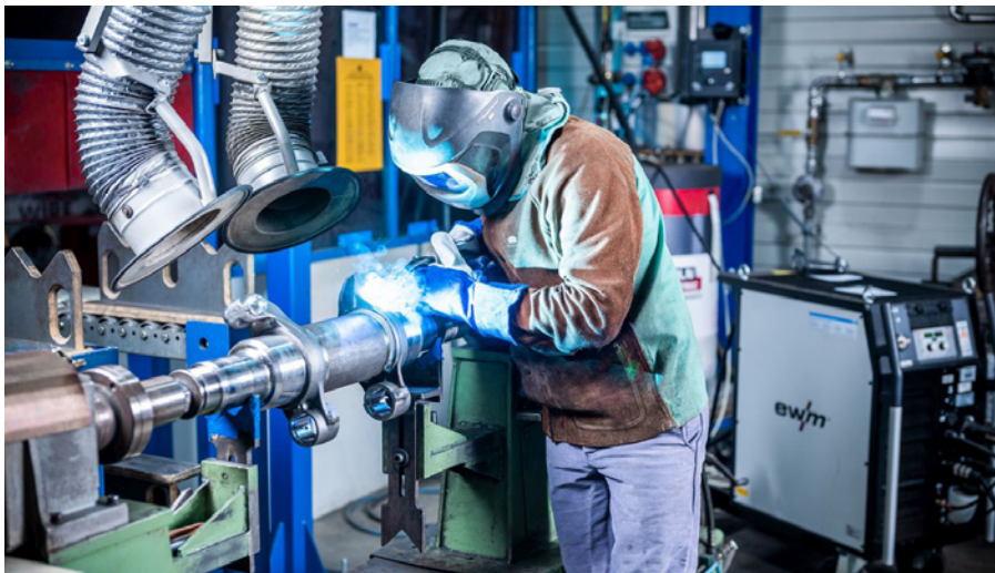
▲ Bild 1. Mit vier Rundnähten werden die beiden Bremsträger per MAG-Verfahren an die Pendelachsen geschweißt. Mithilfe von „ewm Xnet“ werden sämtliche Schweißparameter kontinuierlich überwacht.
