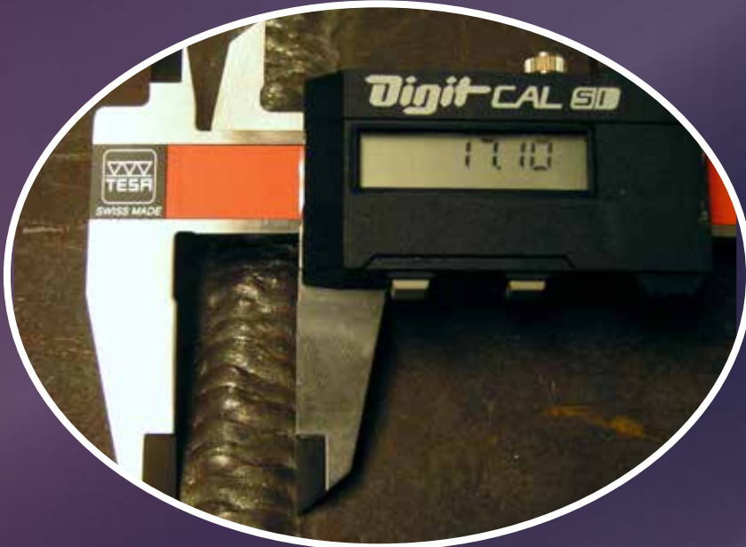
Ein digitaler Messschieber ist nicht genauer als ein mechanischer, aber leichter ablesbar.
