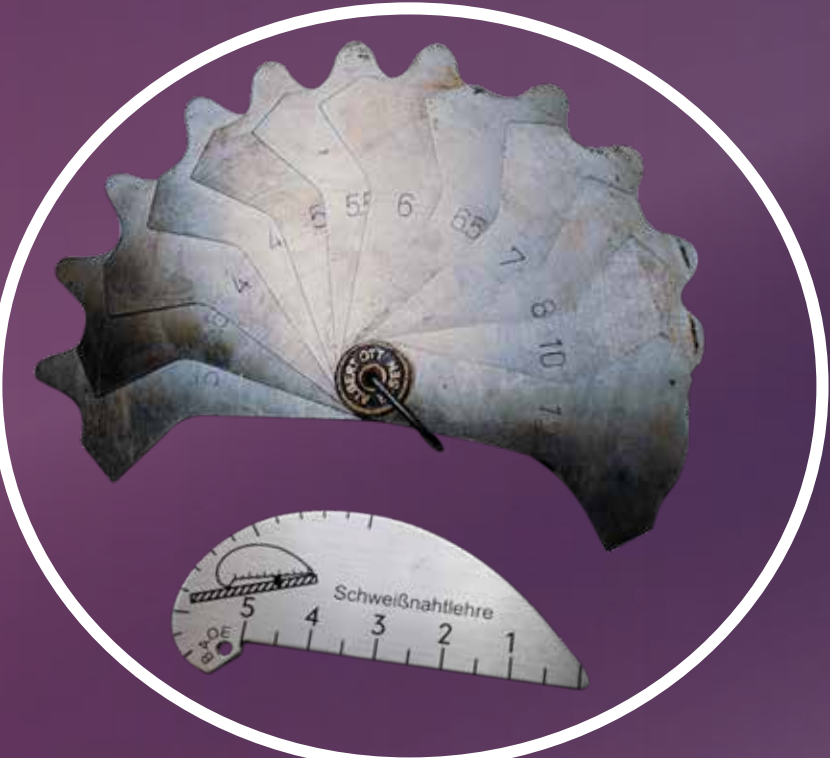
Ein Fächer aus Nahtlehren für verschiedene a-Maße, und eine einfache Nahtlehre
