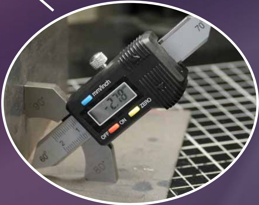
Eine digitale Kehlnahtlehre ist leicht ablesbar. Zusätzlich dienen die Ecken als Schablonen zur Überprüfung von Winkeln.
