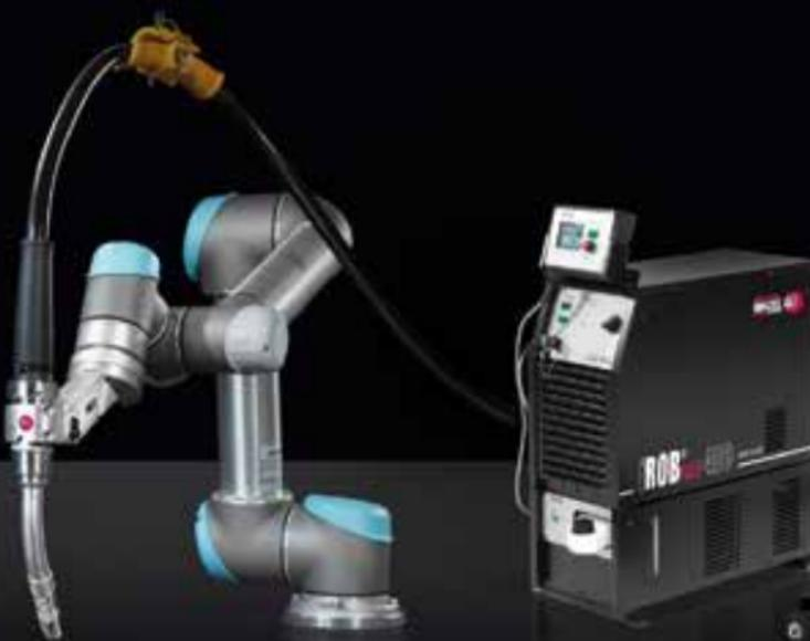
Die ABICOR BINZEL Systemlösung „ROBiPAK“ für luft- oder flüssiggekühlte Anwendungen besteht aus dem kompletten Schweißequipment mit Schweißbrenner, Halter und Schlauchpaket sowie der Stromquelle iROB.
