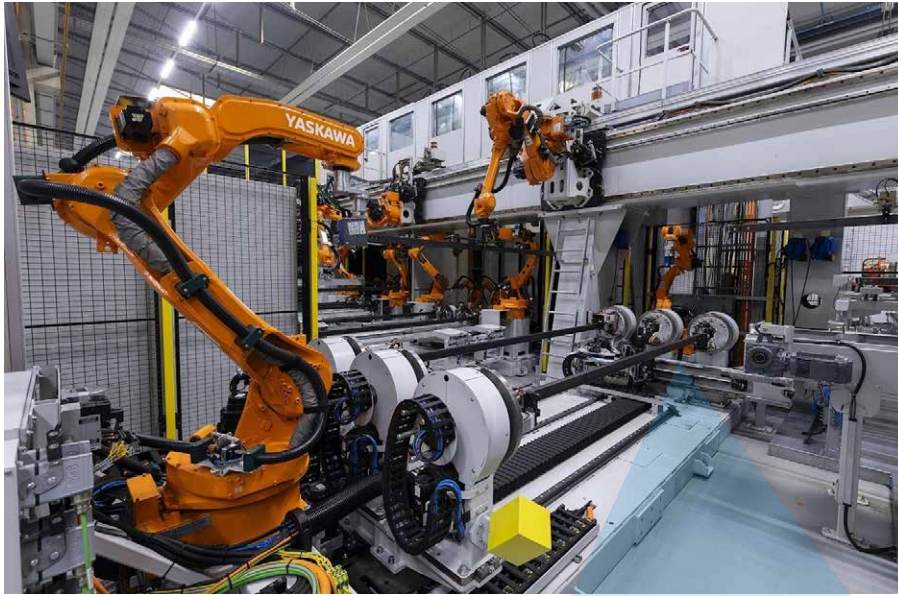
Die insgesamt 18 Motoman-Roboter von Yaskawa arbeiten in der neuen vollautomatischen Schweißanlage für Gerüstteile bei Peri Hand in Hand. (© Yaskawa)
