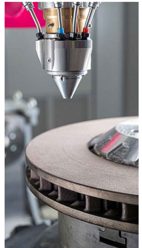
Bremscheibe mit aufgetragener Laserbeschichtung (© Metco Joining & Cladding)
