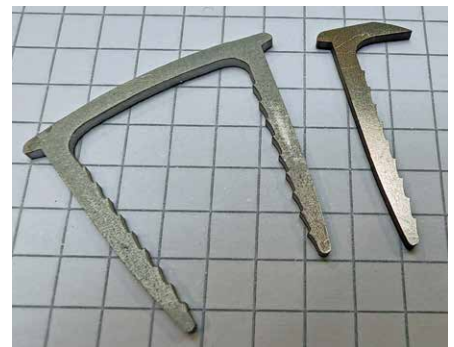
Mit dem LMJ-Verfahren hergestellte Knochenanker aus Nitinol für orthopädische Eingriffe (Bild: Klaus Vollrath)
