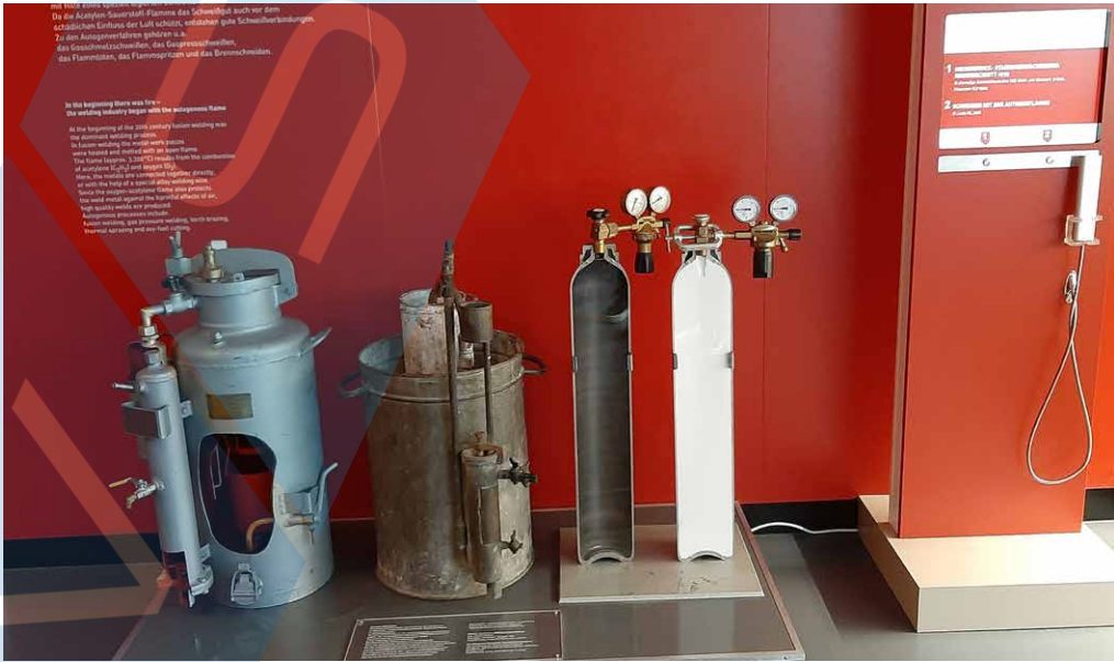
Bild 3.Historischer Azetylen Entwickler und Druckgasflasche (© PhanTECHNIKUM)
