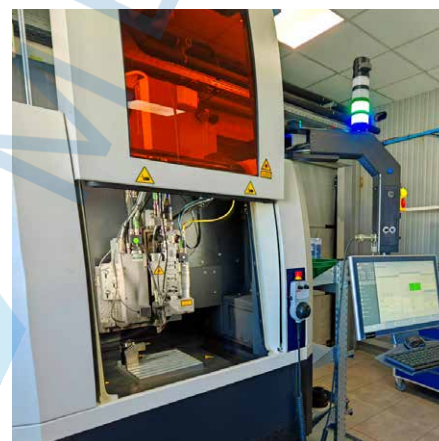
Die bei Microweld seit März 2023 installierte dreiachsige Laser MicroJet-Anlage des Typs LCS 150 verfügt über eine zusätzliche Rotationsachse (© Klaus Vollrath)
