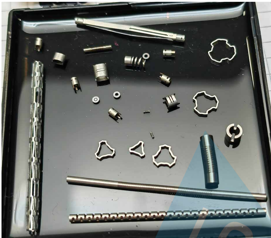
Eine Auswahl von bei Microweld hergestellten Mikrobauteilen, darunter ein Stent für die Stabilisierung von Adern sowie eine Schneidvorrichtung zur Beseitigung von Kalkablagerungen in Blutgefäßen. (© Klaus Vollrath)
