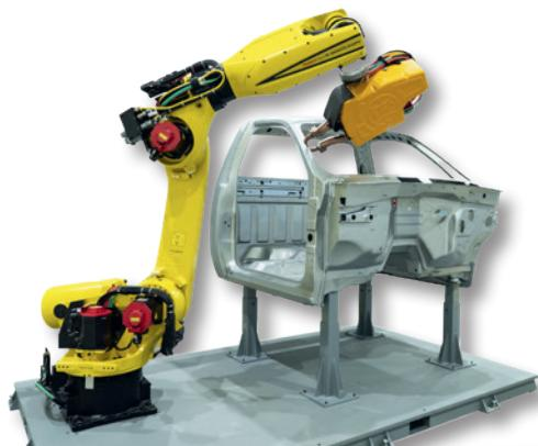
Punktschweißanwendung mit einem Fanuc R-2000iD-Industrieroboter
