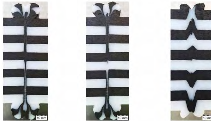
Bild 6: Visualisierung des Schmelzefflusses bei unterschiedlichen Fügestrategien (Wanddicke 100 mm); links: Fügestrategie 1; Mitte: Fügestrategie 3; rechts: Dual-Low-Pressure-Prozess nach ISO 21307 (Fügedruck 0,15 MPa, Aufrechterhaltung des Fügedrucks für 10 s)
