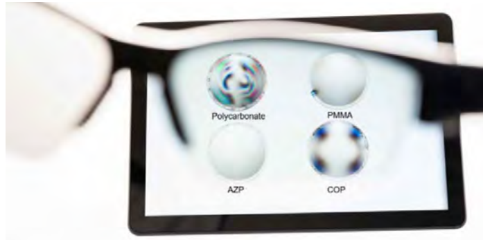
Vergleich der optischen Leistung von AZP und herkömmlichen optischen Polymeren (© Asahi Kasei Europe GmbH)
