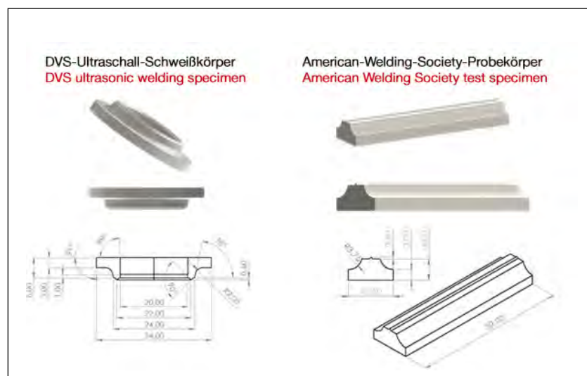
Bild 2: Darstellung der verwendeten oberen Probekörpergeometrien
