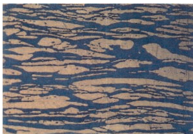
Bild 3. Farbgeätzter Schliff des Duplexstahls 1.4462 – die durch Walzen länglichen Austenitausscheidungen sind hell gefärbt, das Ferritgefüge ist blau.
