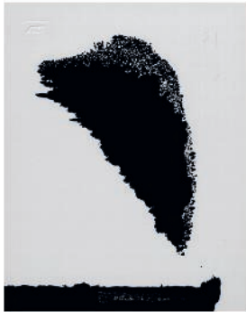
Bild 2. Selektiver Korrosions- angriff; oben: ge- rader Rohr- abschnitt, unten: Rohr- bogen.
