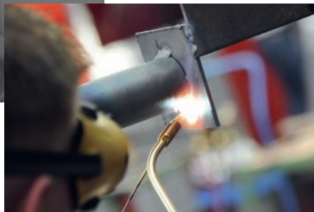
Beim DVS-Wettbewerb „Jugend schweißt“ 2015: Schweißen der Prüfstücke mit dem Wolfram-Inertgasverfahren (links) und dem autogenen Gasprozess (rechts)
