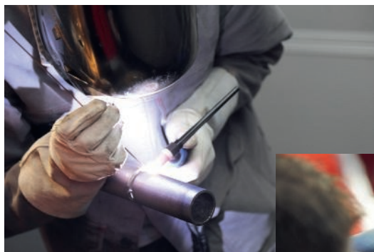
Beim DVS-Wettbewerb „Jugend schweißt“ 2015: Schweißen der Prüfstücke mit dem Wolfram-Inertgasverfahren (links) und dem autogenen Gasprozess (rechts)
