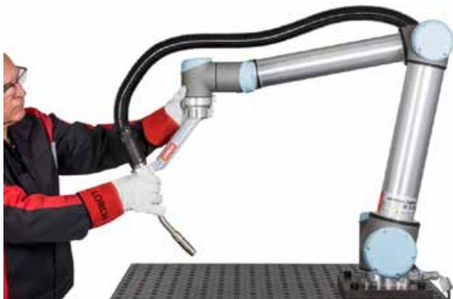
Bild 11 • Leichtbauroboter zum kollaborierenden Schweißen (Cobot).
