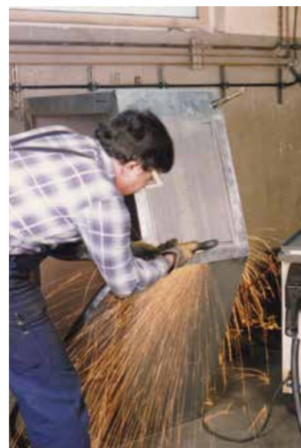
Bild 12 • Plasmaschneiden mit kleinem Werkstattgerät. (Foto: Messer Group)
