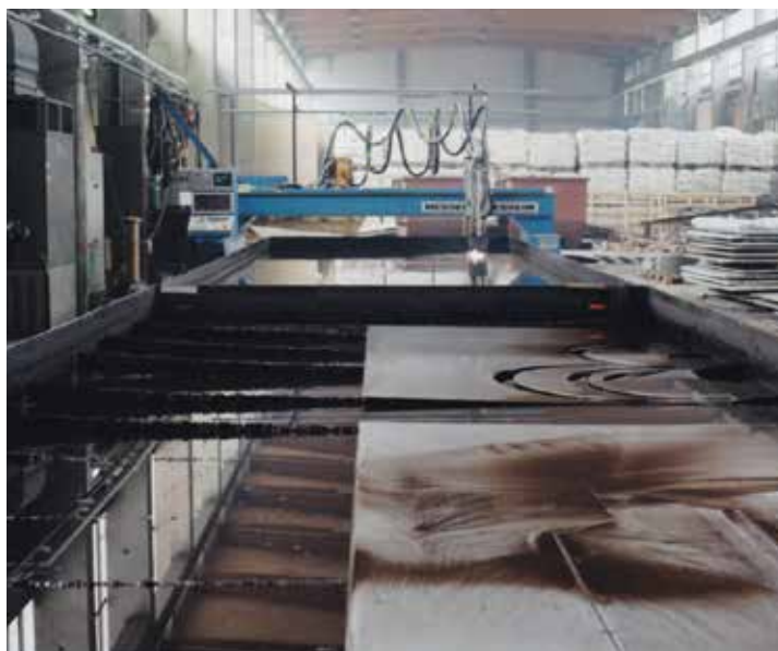
Bild 9 • Unterwasser-Schneidanlage. (Foto: Messer Group)
