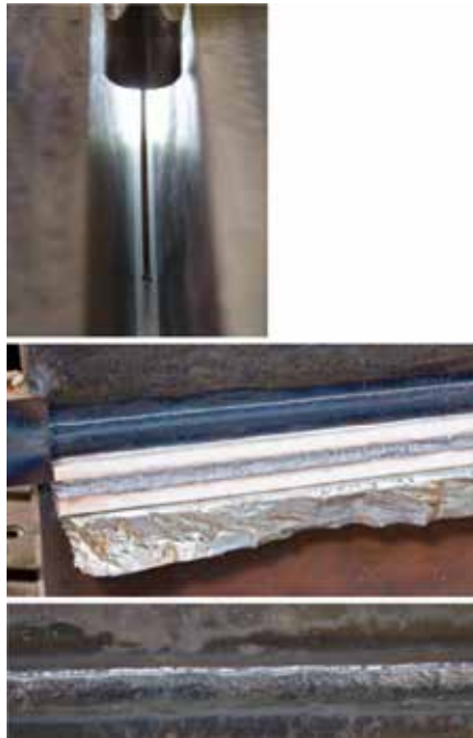
Bild 20 • Langer Stick-out; oben: Schweißen der Wurzellage, Mitte: Keramikbadstütze, unten: Wurzelbildung.
