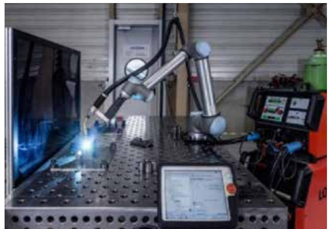
Bild 12 • Beispiel eines Cobot-Arbeitsplatzes. (Foto: Lorch)
