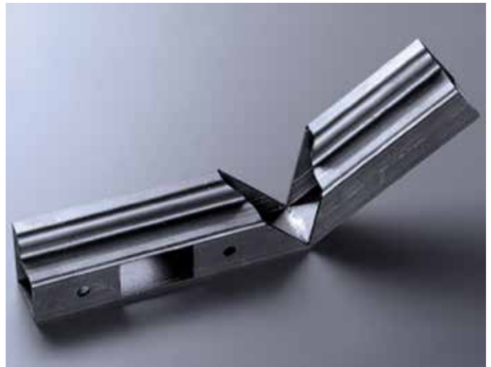
Laserbearbeitetes Rohrbauteil zum Knicken. (Bild: Metallbau Nick)
