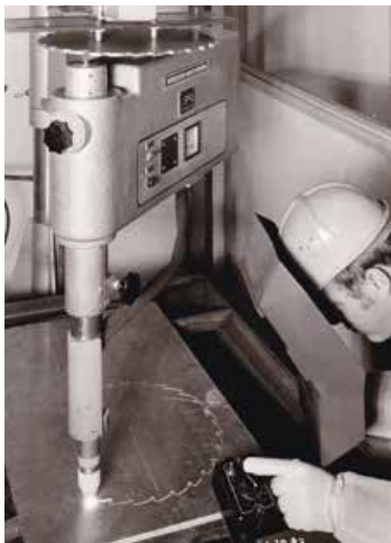
Bild 10 • Plasmaschneiden mit Gelenkarm-Schneidmaschine. (Foto: Messer Group)
