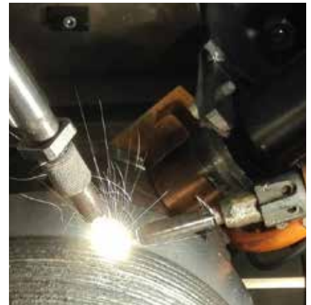
Bild 24 • Laserstrahl-Pulver-Heißdrahtschweißen mit Partikelbeschleuniger.
