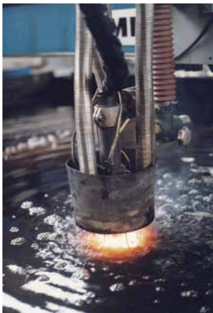
Bild 8 • Plasmaschneiden unter Wasser. (Foto: Messer Group)
