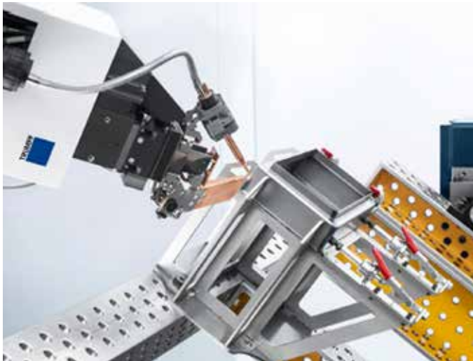
Schweißen eines Bauteils mit einem Laserstrahlschweißroboter (Bild: Trumpf Gruppe)
