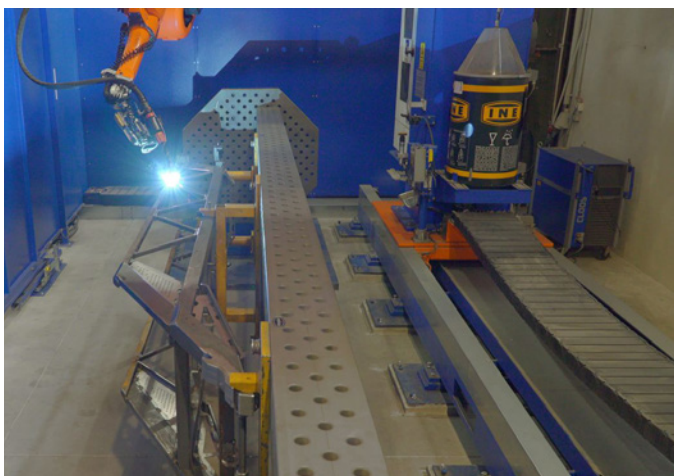
▲ Bild 4. Das Werkstück wird zwischen zwei vertikal angeordnete Planscheiben montiert.
