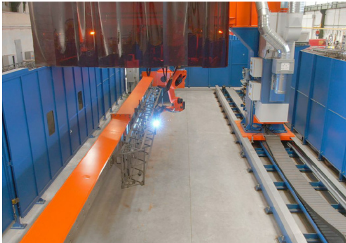
▲ Bild 2. Der Roboter verfügt über einen stark erweiterten Arbeitsraum, da er über Kopf an einer Bodenfahrbahn mit Vertikal- und Horizontalhub montiert ist.
