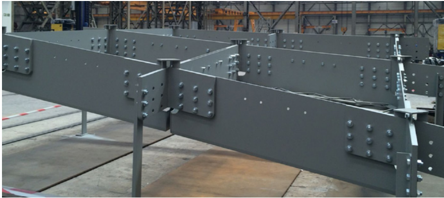
▲ Bild 13. Probesegment – aus vielen tausend solcher Dachsegmente entsteht die geschwungene Dachform des neuen Flughafengebäudes.
