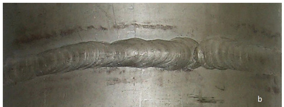
▲ Bild 3. Vergleich des Schweißnahtaussehens von WIG-geschweißten Rohrrundnähten aus CrNi-Stahl 1.4571: WIG-Orbitalschweißung (a), manuelle WIG-Schweißung (b)
