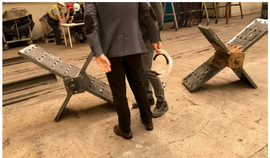
▲ Bild 12. Geschweißte Knotenbleche vor der Sortierung
