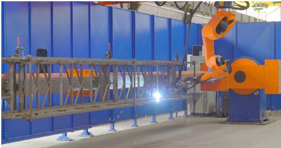
▲ Bild 1. Zwei baugleiche Roboteranlagen schweißen Drehleiterelemente für Feuerwehruhubfahrzeuge.
