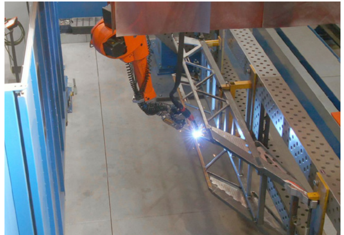
▲ Bild 3. Eine weitere kompakte Roboteranlage schweißt den Korbarm für die Gelenkleitern und verschiedene Kleinteile.
