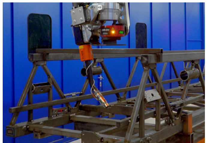
▲ Bild 5. Beim parallel zur Brennerspitze montierten Laser-Online-Sensor erfolgt das Vermessen der Bearbeitungsstrecke online während des Schweißens. (Bilder: Cloos)
